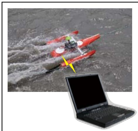
曳航フロートと組み合わせる事により、ボート-PC間をケーブルレスで通信することが可能です。これにより、データをリアルタイムモニタリングしながら取得することが出来ます。
