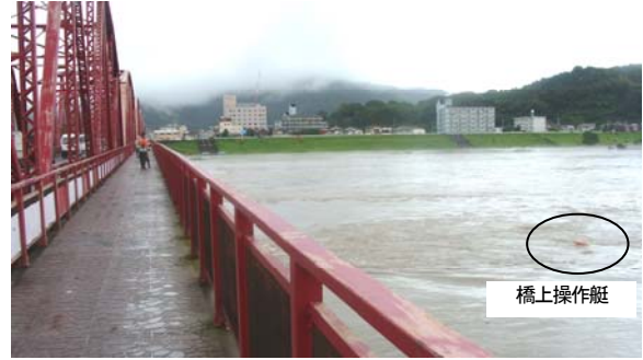
図-5 橋上操作艇による曳航計測状況
