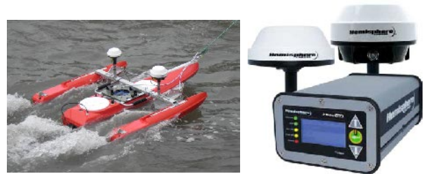
図5 RTK-GPS コンパス搭載機
