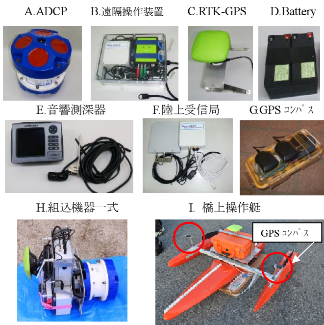
図1 可搬型洪水観測システムの機器構成
